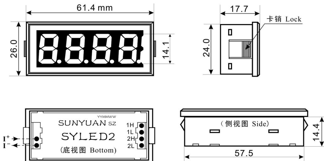
1L/1H: 第一路报警输出 (低电平) Low level
